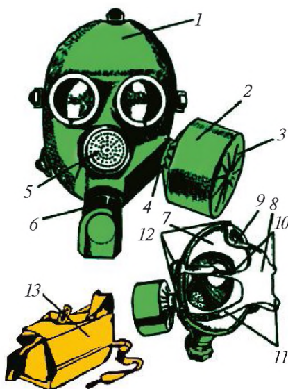
13-rasm. GP-5 gazniqobi: 1 — niqob; 2 — havo tozalovchi quti; 3 — trikotajdan qilingan g'ilof; 4 — nafas olish naychasining og'zi; 5 — gaplashish moslamasi; 6 — nafas chiqarish naychasi; 7 — obturator; 8 — tepalik; 9 — peshana bog'ichi; 10 — chakka bog'ichi; 11 — iyak osti bog'ichi; 12 — uzaytirib qisqartiradigan bog'ich; 13 — jild.
