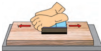
17-rasm. Buyum yuzasini jilvirlash qoidasi.
