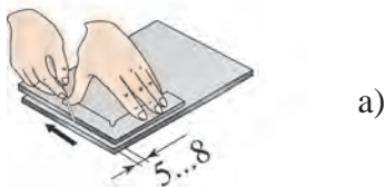
45-rasm. Tunuka listlarni tekislash qoidalari.
