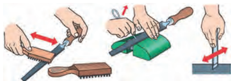
14-rasm. Egovni tozalash usullari.
