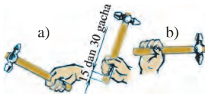
65-rasm. Kesishda bolgʻaning dastasini ushlab usullari:
